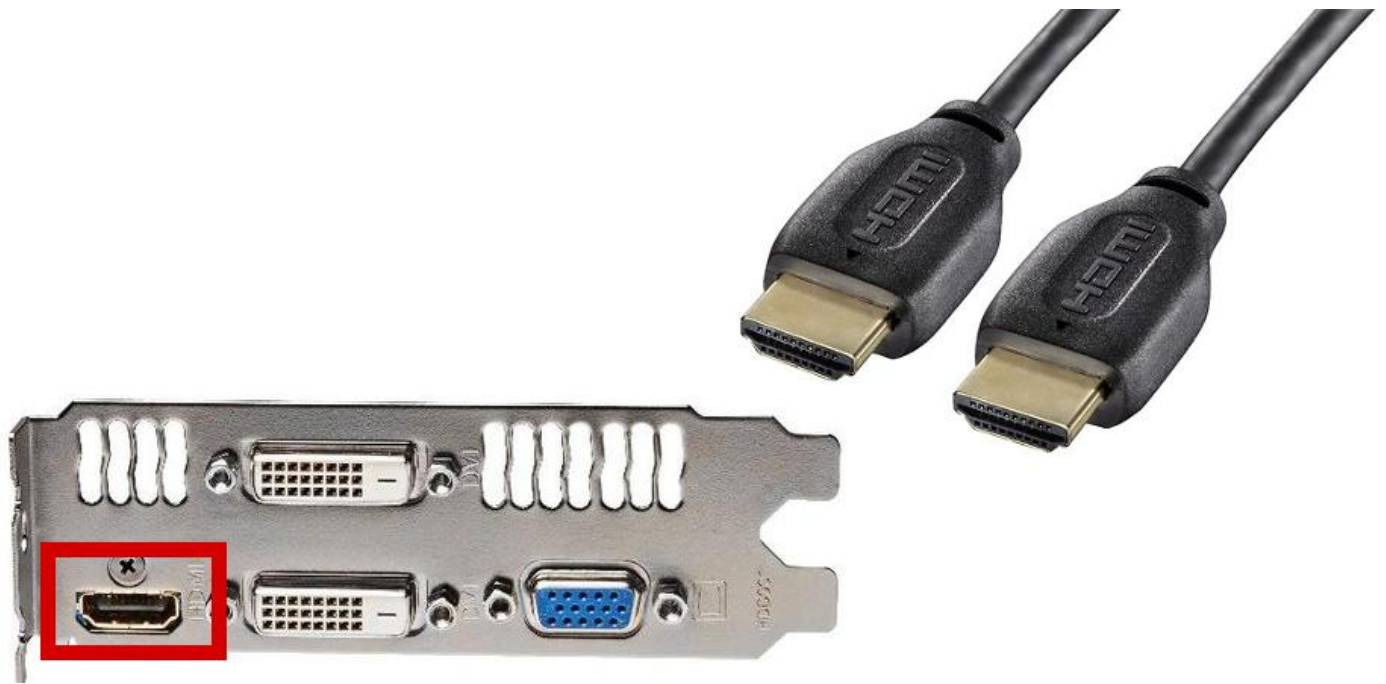
Standardowy kabel HDMI z zaznaczonym gniazdem na karcie graficznej
