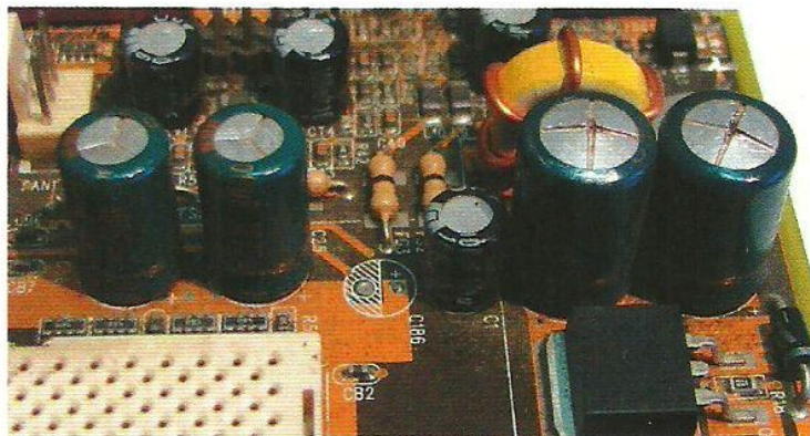
Rys. 3.2. Przykład dobrych kondensatorów (po lewej) oraz napuchniętych (po prawej)
